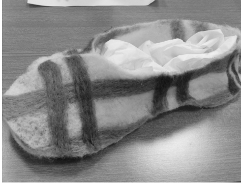
Campione realizzato con agugliatrice manuale: prototipo di pantofola realizzata con tessuto-non-tessuto
