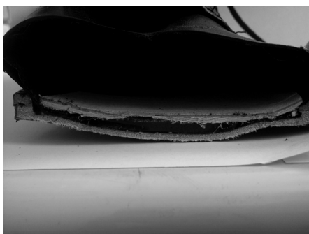
Figura 15: Dettaglio in sezione della suola con smart materials
