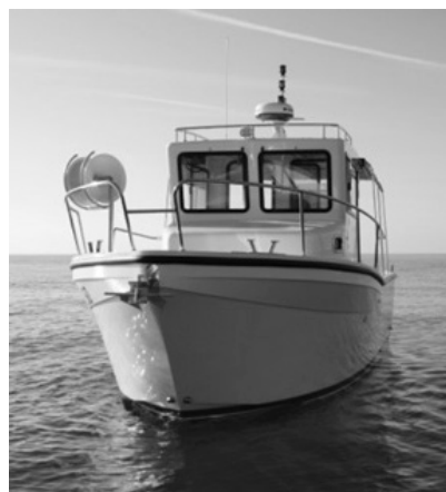
Figura 10: Barca in fibra di basalto, prodotto finito
