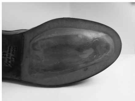
Figura 13: Zona della suola con finestra sul riempitivo interno in smart material
