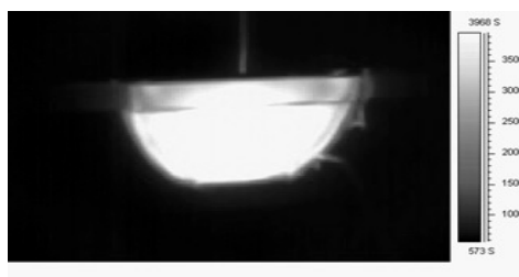
Figura 7: Registrazione con termocamera della prova di resistenza al getto incendiato
