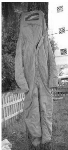
Figura 8: Tuta antincendio in fibra di basalto
