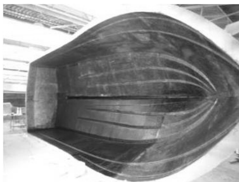
Figura 9: Barca in basalto nelle fasi di rifinitura dello scafo
