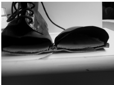
Figura 14: Sezione della nuova calzatura prototipale
